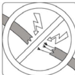
Controleer op beschadigde draden
